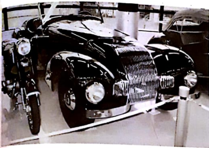
Allard Palm Beach montado com um motor V8 Cadillac ou Ford. O Allard era um carro bem esportivo feito na Inglaterra. Caixa de três marchas no piso, suspensão Ford com eixo bipartido na frente e carroceria de alumínio para ser leve: 850 kg. A seu lado uma Jawa 250 tcheca dos anos 50
