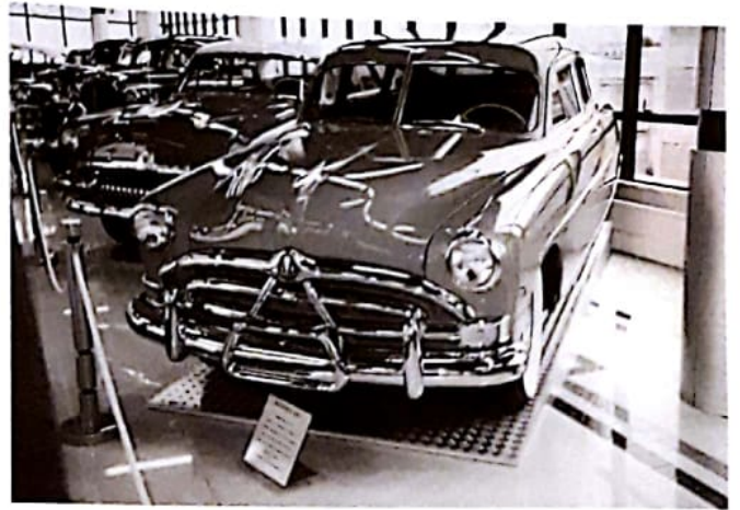
A Hudson 51 tinha o maior motor de seis cilindros em linha de sua época. Os cinco litros de capacidade lhe davam 180 cavalos com a dupla carburação opcional e a marca teve anos de glória nas pistas de Stock Car americanas, até que surgisse o Oldsmobile Rocket V8.
