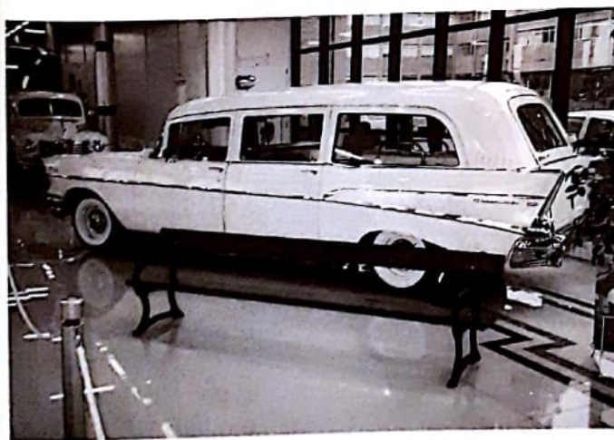
Ambulância Chevrolet 57 A carroceria alongada foi fabricada pela Hess & Eisenhardt, tradicional fornecedora de carros fúnebres e limousines para o Governo. O modelo único no Brasil tem o V8 de 4,7 litros e 210 hp, câmbio Powerglide de duas marchas e um opcional raríssimo na época: ar condicionado de fábrica, embutido no painel.
